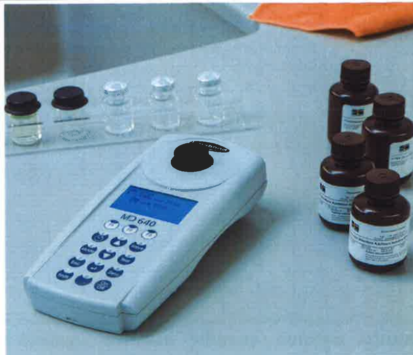
Slika 6.1. Fotometar LOVIBOND MD640
