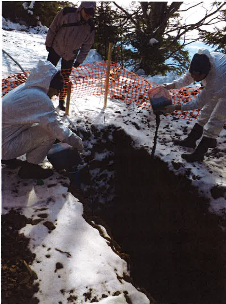
Slika 5. Postupak ulijevanja boje u raskop uz prisustvo nadzora
